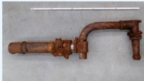
Landingsgestel neuswiel van een WOII North American B-25 Mitchell bommenwerper. Opgebaggerd ter hoogte van de Oosthinder zandbank
